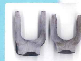
冷間鍛造で作られたヨークは、ファイバーフロー（組織の流れ）効果により、剛性と靱性（しなやかさ）に優れています。
