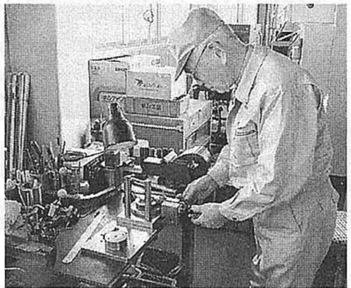
職人が手作業で金型の微調整をする
