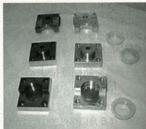
写真4 鉄合金をめっきし表面改質したアルミ金型(左)と通常のアルミ金型(日本プレーテック)
